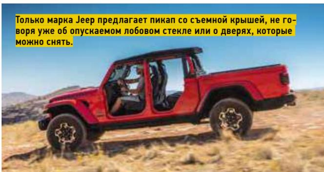
Только марка Jeep предлагает пикап со съёмной крышей, не говоря уже об опускаемом лобовом стекле или о дверях, которые можно снять.
