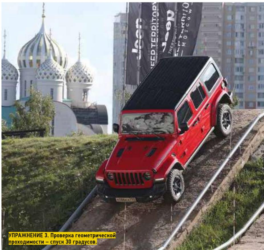
**УПРАЖНЕНИЕ 3.** Проверка геометрической проходимости — спуск 30 градусов.
