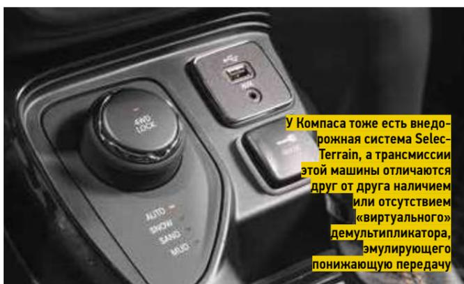
У Компаса тоже есть внедорожная система Selec-Terrain, а трансмиссии этой машины отличаются друг от друга наличием или отсутствием «виртуального» демультипликатора, эмулирующего понижающую передачу
