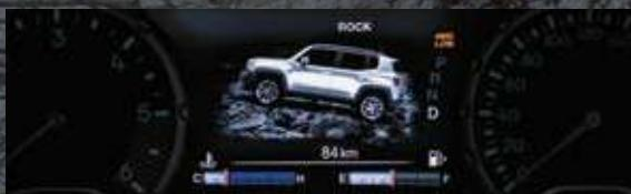
**ROCK (КАМНИ):** Уникальный режим, доступный только для версии Trailhawk, предлагает высокую проходимость (в режиме 4x4) на низкой скорости благодаря режиму Low в трансмиссии и механизму электронной блокировки дифференциалов. Это позволяет Renegade передвигаться по самым сложным ландшафтам, перебрасывая момент на любое из колес.
