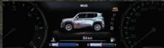
**MUD (ГРЯЗЬ):** Режим допускает пробуксовку колес, чтобы повышать силу сцепления с поверхностью. Благодаря специальным настройкам системы управления полным приводом в этом режиме автомобиль стремиться получить максимальное сцепление. Выискивая колесами твердые участки покрытия и цепляясь за них, он «пробивается» сквозь грязь.
