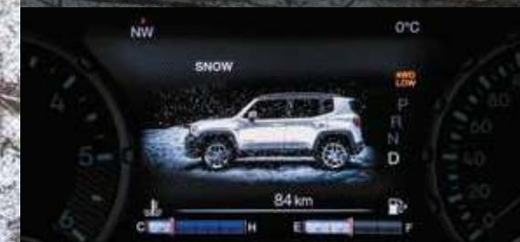
**SNOW (СНЕГ):** Повышает устойчивость и минимизирует избыточную поворачиваемость, обеспечивая безопасность и высокие ездовые характеристики на заснеженных и обледенелых дорогах. Основные системы работают таким образом, чтобы обеспечивать устойчивое движение.
