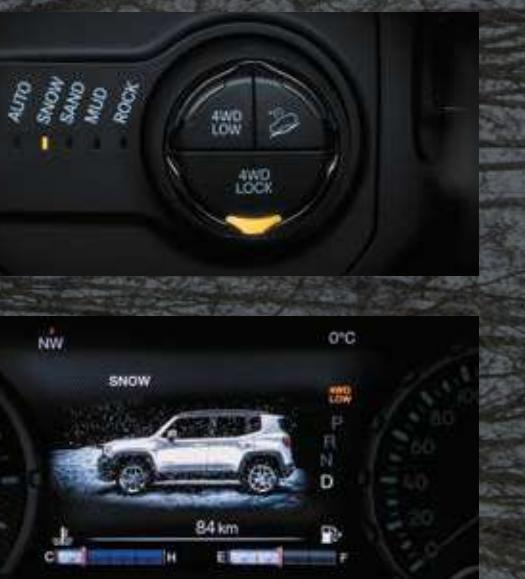
**SNOW (СНЕГ):** Повышает устойчивость и минимизирует избыточную поворачиваемость, обеспечивая безопасность и высокие ездовые характеристики на заснеженных и обледенелых дорогах. Основные системы работают таким образом, чтобы обеспечивать устойчивое движение.
