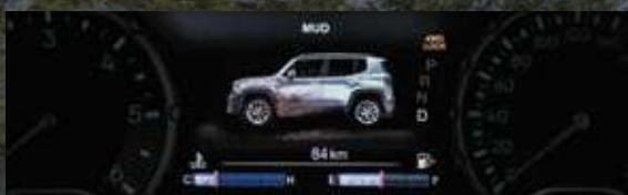
**MUD (ГРЯЗЬ):** Режим допускает пробуксовку колес, чтобы повышать силу сцепления с поверхностью. Благодаря специальным настройкам системы управления полным приводом в этом режиме автомобиль стремится получить максимальное скольжение. Выискивая колесами твердые участки покрытия и цепляясь за них, он «пробивается» сквозь грязь.
